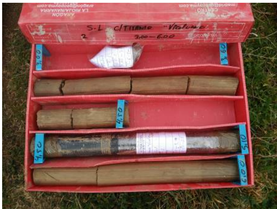
PERFIL LITOLOGICO DEL SONDEO S-1 DE 3,00 A 6,00 m
