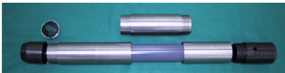
Fotografía 2. Tomamuestras de pared gruesa utilizado para obtener muestras inalteradas del terreno.
