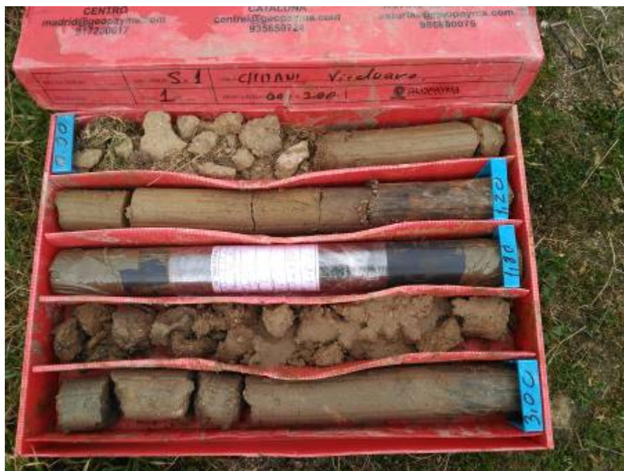
PERFIL LITOLÓGICO DEL SONDEO S-1 DE 0,00 A 3,00 m
