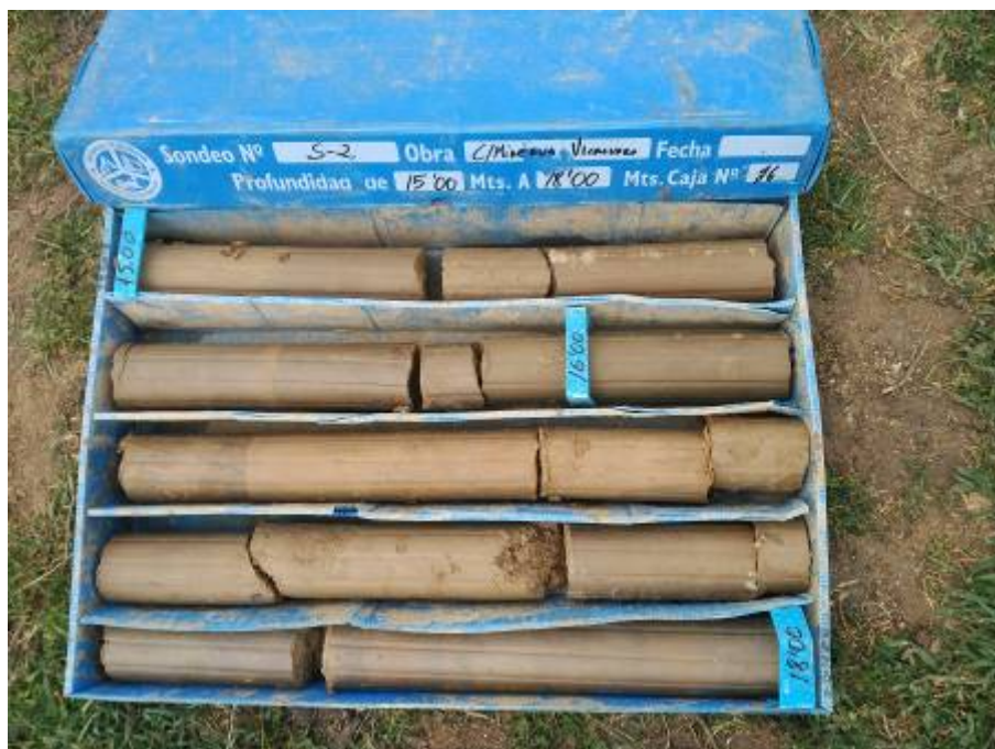
PERFIL LITOLÓGICO DEL SONDEO S-2 DE 15,00 A 18,00 m
