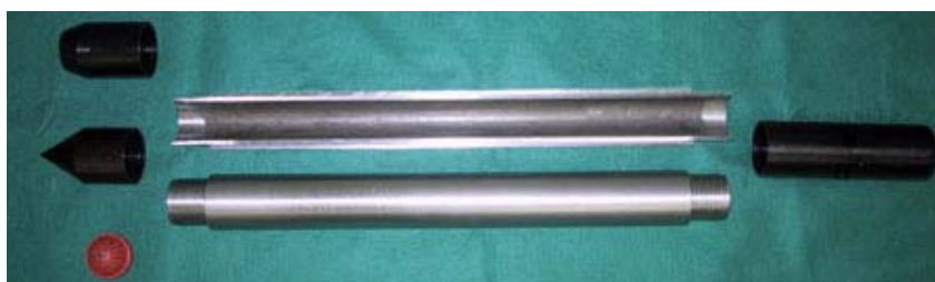
Fotografía 1. Cuchara estándar utilizada para el ensayo de penetración estándar S.P.T.
