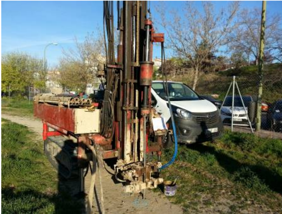
ENSAYO DE PENETRACIÓN DINÁMICA DPH 6
