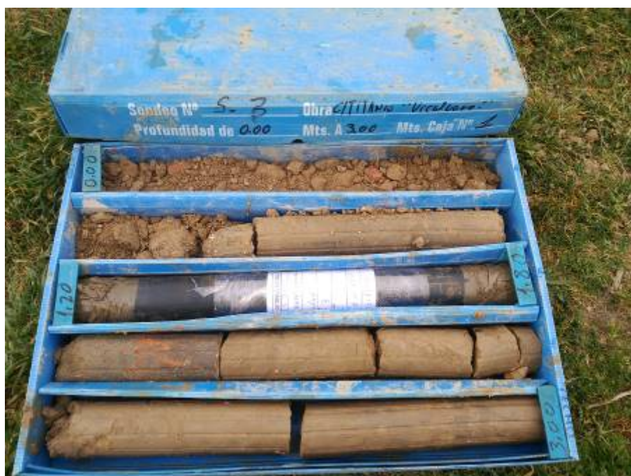
PERFIL LITOLÓGICO DEL SONDEO S-3 DE 0,00 A 3,00 m
