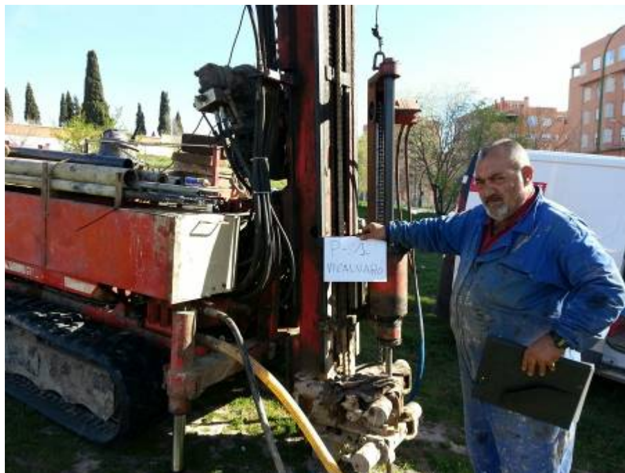
ENSAYO DE PENETRACIÓN DINÁMICA DPSH 1
