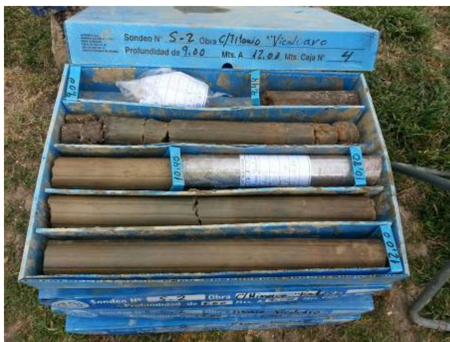
PERFIL LITOLOGICO DEL SONDEO S-2 DE 9,00 A 12,00 m
