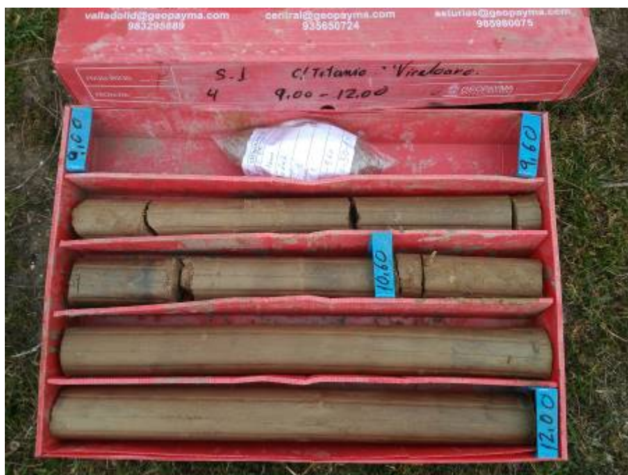
PERFIL LITOLÓGICO DEL SONDEO S-1 DE 9,00 A 12,00 m
