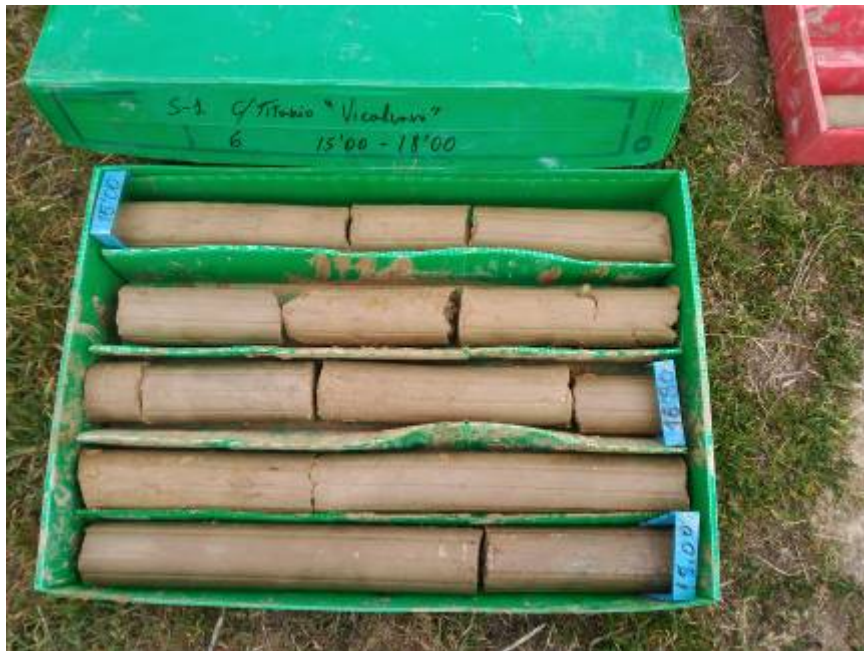
PERFIL LITOLÓGICO DEL SONDEO S-1 DE 15,00 A 18,00 m
