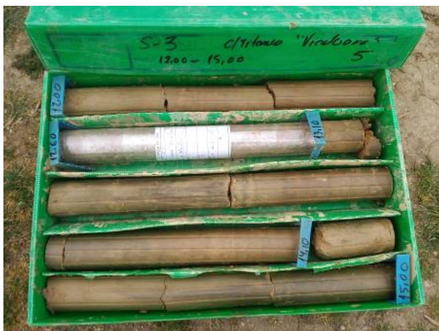
PERFIL LITOLÓGICO DEL SONDEO S-3 DE 12,00 A 15,00 m
