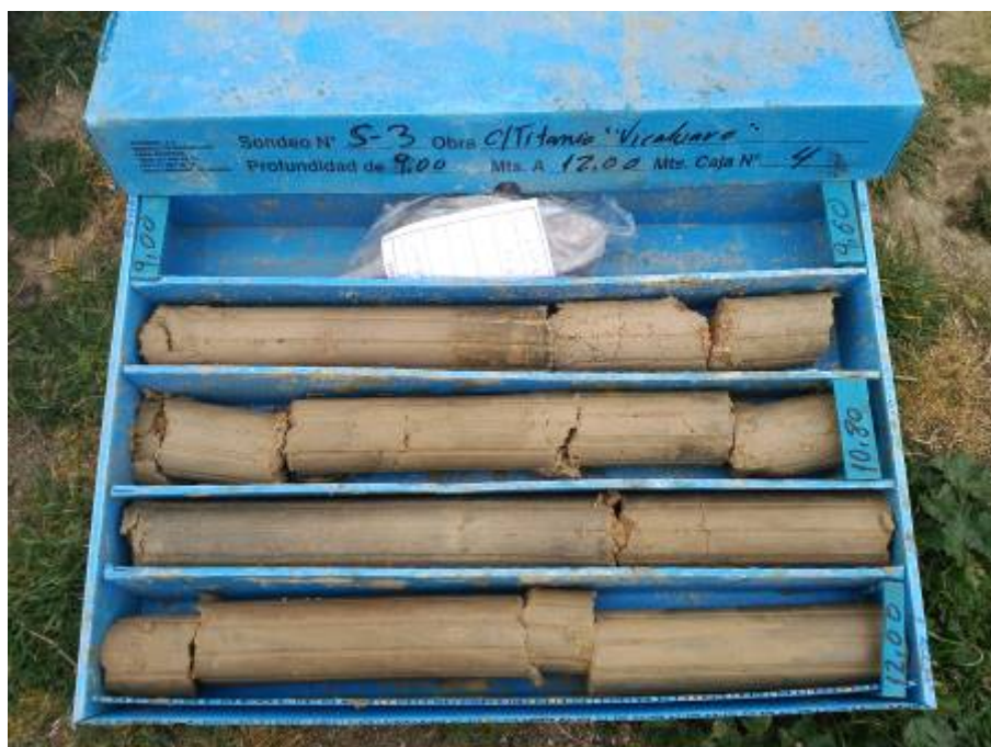
PERFIL LITOLÓGICO DEL SONDEO S-3 DE 9,00 A 12,00 m
