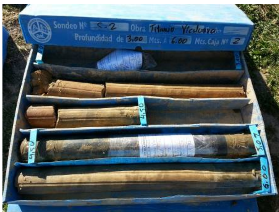
PERFIL LITOLOGICO DEL SONDEO S-2 DE 3,00 A 6,00 m
