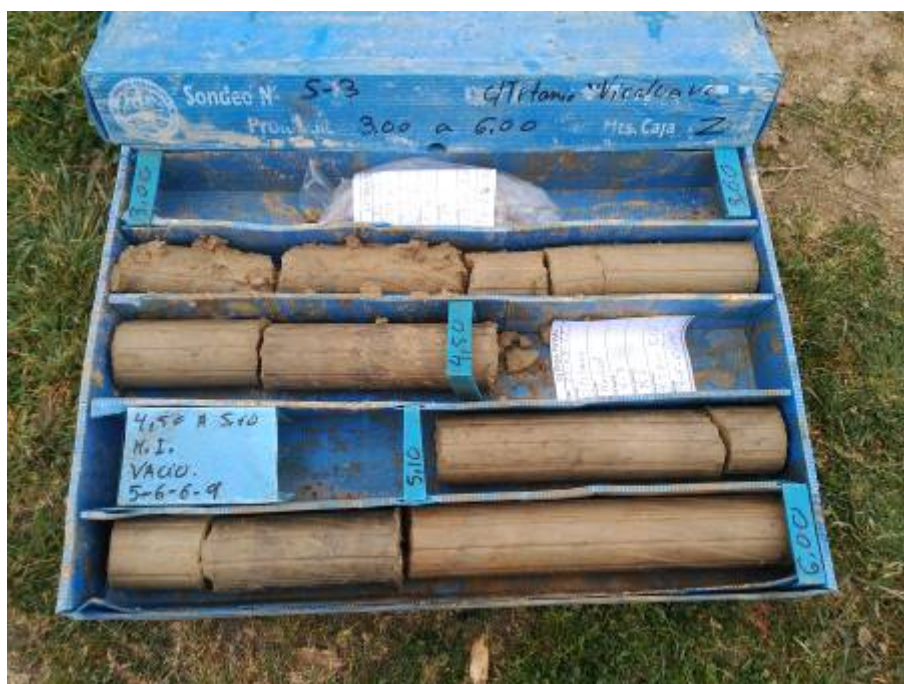
PERFIL LITOLOGICO DEL SONDEO S-3 DE 3,00 A 6,00 m
