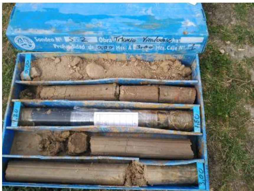
PERFIL LITOLOGICO DEL SONDEO S-2 DE 0,00 A 3,00 m
