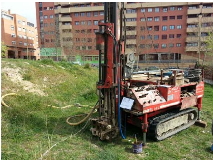
ENSAYO DE PENETRACIÓN DINÁMICA DPSH 3
