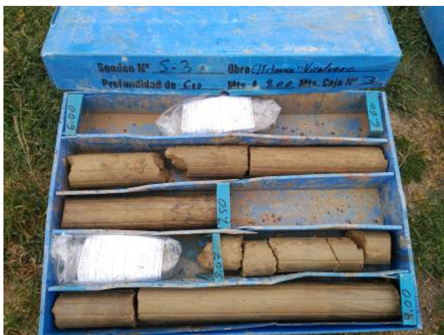
PERFIL LITOLOGICO DEL SONDEO S-3 DE 6,00 A 9,00 m
