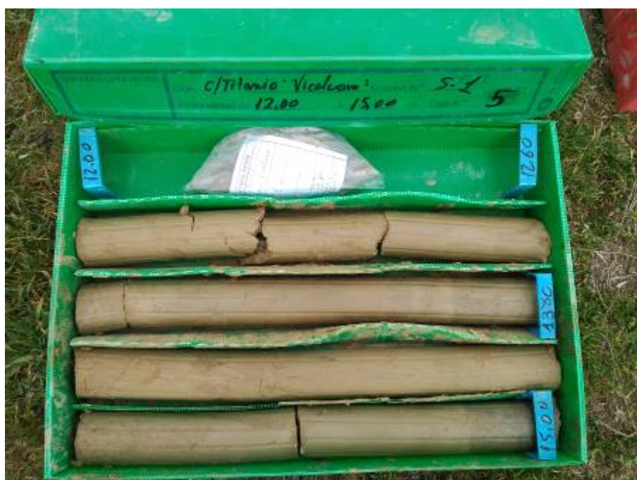
PERFIL LITOLÓGICO DEL SONDEO S-1 DE 12,00 A 15,00 m
