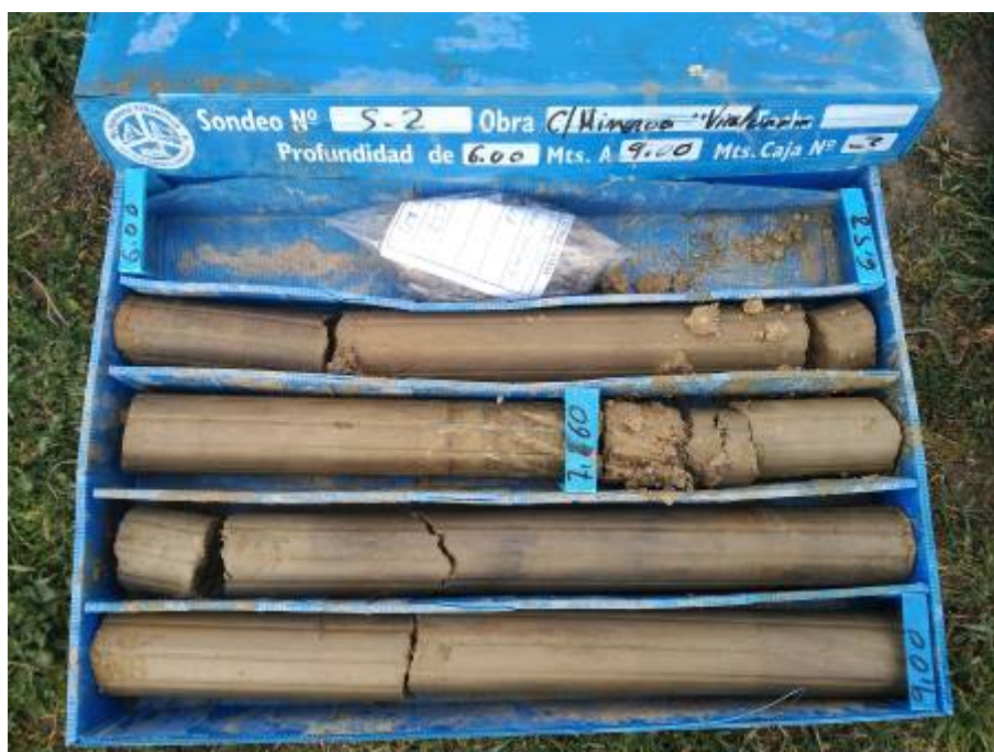
PERFIL LITOLOGICO DEL SONDEO S-2 DE 6,00 A 9,00 m
