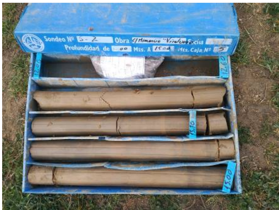
PERFIL LITOLÓGICO DEL SONDEO S-2 DE 12,00 A 15,00 m
