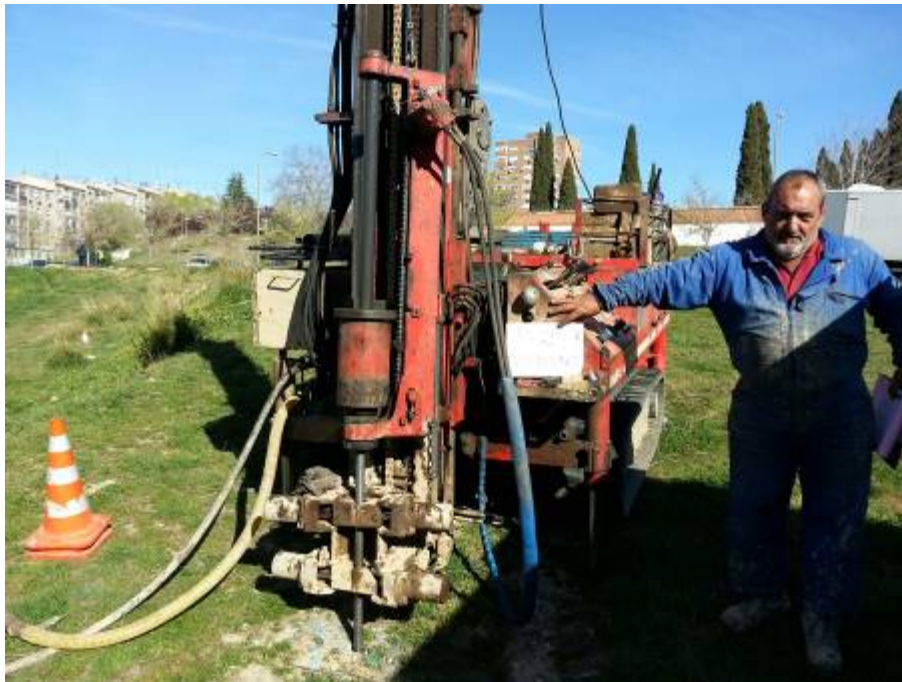
ENSAYO DE PENETRACIÓN DINÁMICA DPSH 2
