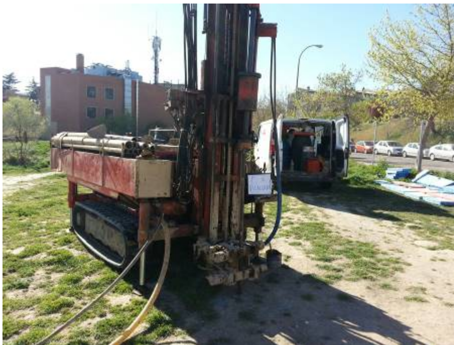
ENSAYO DE PENETRACIÓN DINÁMICA DPSH 5
