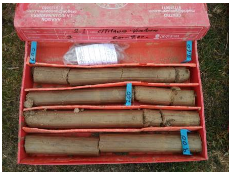
PERFIL LITOLOGICO DEL SONDEO S-1 DE 6,00 A 9,00 m
