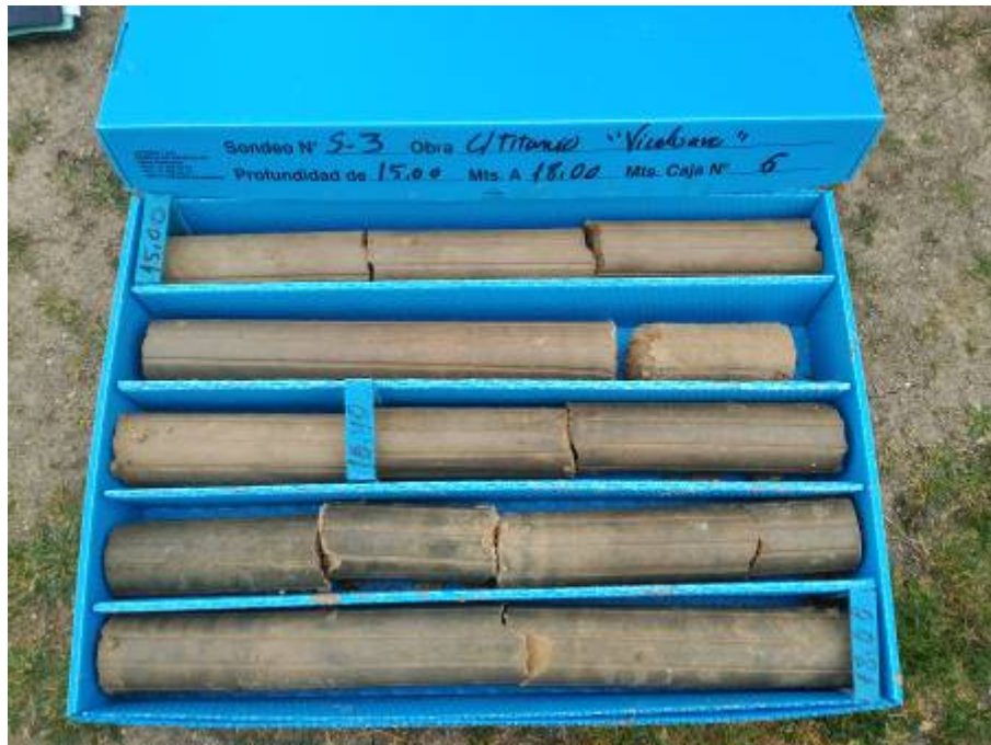
PERFIL LITOLÓGICO DEL SONDEO S-3 DE 15,00 A 18,00 m
