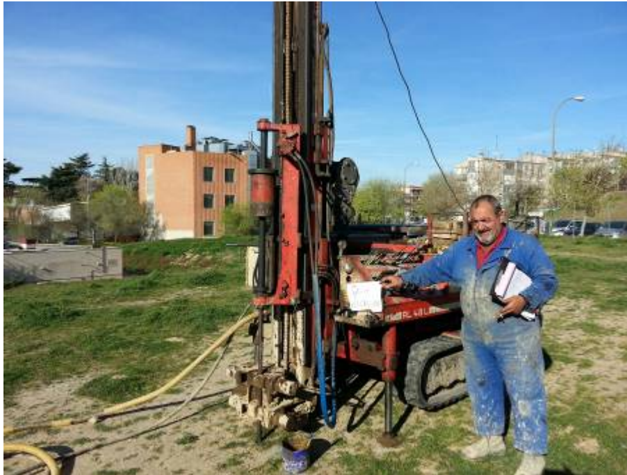
ENSAYO DE PENETRACIÓN DINÁMICA DPSH 4
